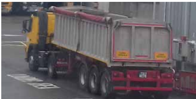
Leantóir alúmanaim 30 Tona chun salann bóthair a tharraingt ó na poirt go sciobóil salainn na Comhairle
